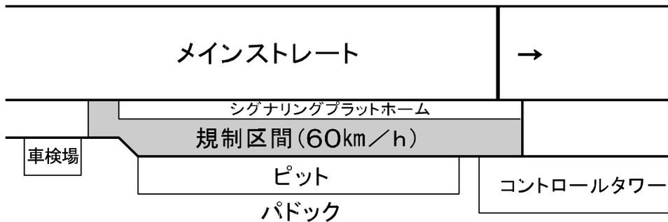
3. ピット前の直線部分に区画されたプラットホームと黄線の間は、ピットインおよびピットアウト専用の通路ピット走行レーン、黄線と黄線の間は補助レーン、黄線とピットの間はピット作業のための作業エリアとなる。
