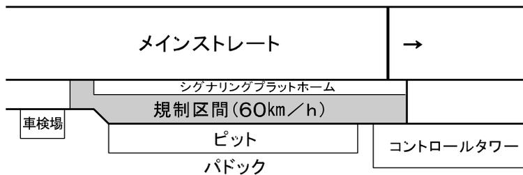
3. ピット前の直線部分に区画されたプラットフォームと黄線の間は、ピットインおよびピットアウト専用の通路ピットレーン（走行レーン）、黄線と黄線の間は補助レーン、黄線とピットの間はピット作業のための作業エリアとなる。
