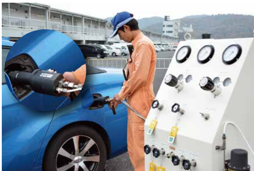
写真：FCV 車両に充填しているところ
