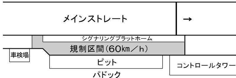
3. ピット前の直線部分に区画されたプラットフォームと黄線の間は、ピットインおよびピットアウト専用の通路ピット走行レーン、黄線と黄線の間は補助レーン、黄線とピットの間はピット作業のための作業エリアとなる。
